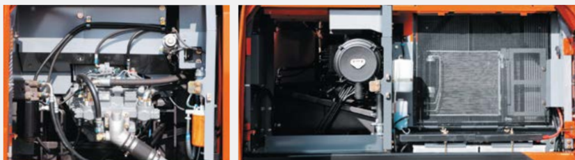
Расположенные вместе выносные фильтры и точки ежедневной проверки
