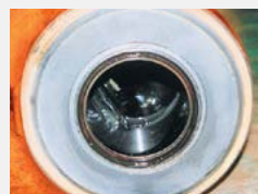
Термическое напыление WC (карбид вольфрама)
