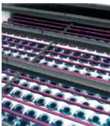
Воздушный трубопровод, расходомеры, пылевые мешки и сепараторы предварительно смонтированы на рукавном фильтре.
