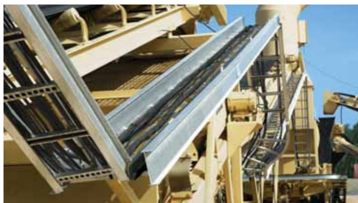
Поддоны для кабелей поставляются со всеми компонентами завода M-Pack, держат обрезиненные кабели вместе и не дают касаться земли.
