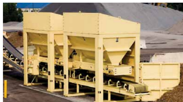
Разделяет РАП на два размера для более эффективного использования.
